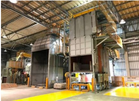
เครื่อง MRM สำหรับดึงอลูมิเนียมในขั้นตอนอลูมิเนียม DROSS กลับไปหลอมใหม่
