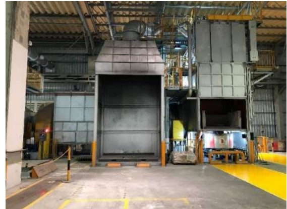
เครื่อง MRM สำหรับดึงอลูมิเนียมในขั้นตอนอลูมิเนียม DROSS กลับไปหลอมใหม่
